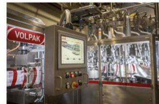
La macchina SC+ è un'unità orizzontale per il riempimento e sigillatura di packaging flessibile a movimento continuo. (foto: Volpak)
