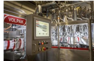
La macchina Volpak SC+ è un'unità di riempimento e sigillatura continua orizzontale a movimento continuo per il packaging flessibile. (foto: Volpak)
