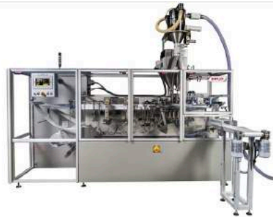
Dédiée à la production et au remplissage de sachets à trois ou quatre soudures, la F11 DX Duplex affiche une cadence de 100 cycles par minute.
