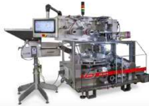
La macchina ACMA CW 800 R, una confezionatrice per praline di cioccolato tonde. (foto: ACMA)
